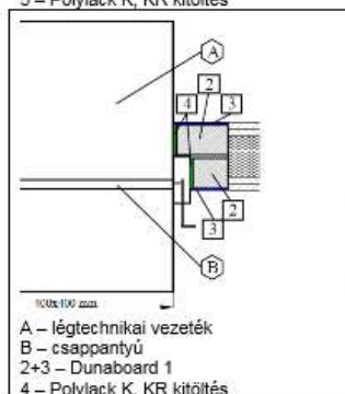
Kábelátvezetés EI 120 A1, A2, A3 – kábelek kábeltálcán Polylack F bevonattal 4 – Dunaboard 4 5 – Polylack K, KR kitöltés
